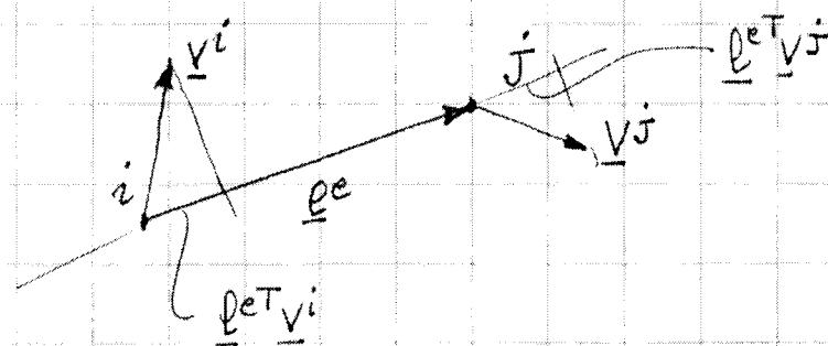
Gli spostamenti infinitesimi  $\underline{v}^i$  e  $\underline{v}^j$  devono essere tali da rendere le distanze  $|\underline{e}^e| = \sqrt{\underline{e}^{eT} \underline{e}^e}$  invariate. A tal fine le proiezioni degli spostamenti sull'asse delle trave devono essere uguali:
